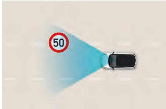
Asistente inteligente de límite de velocidad (ISLA). Este sistema emite alertas acústicas y visuales si circulas por encima de la velocidad permitida en la vía. Además, te avisa para que cambies la velocidad establecida en el Asistente de límite de velocidad manual o en el Control de crucero inteligente a fin de respetar los límites fijados.
