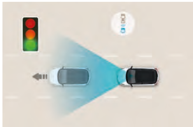
Sistema de alerta de inicio de la marcha (LVDA). Esta ingeniosa función para circular por ciudad advierte al conductor cuando el vehículo que circula delante retoma la marcha tras detenerse, por ejemplo, en un semáforo o a consecuencia de un atasco.
